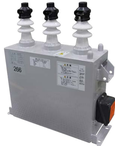
PET-FK4形 7.02kV 3相 50Hz 266kvar
