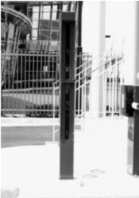
図 11 赤外線センサ（計量棟入口用）
