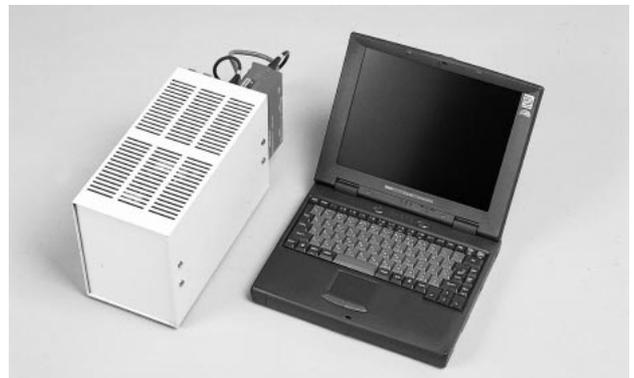
図 11 CVT 内部部分放電検出装置
