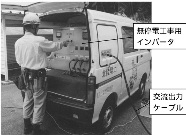
図4 無停電工専用電源車
