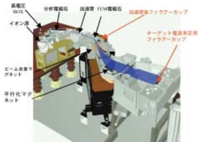
図1 中電流イオン注入装置 (EX2300H)
