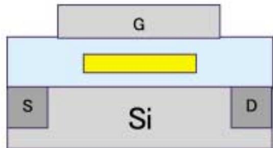
図3 従来タイプのフローティングゲートメモリー
