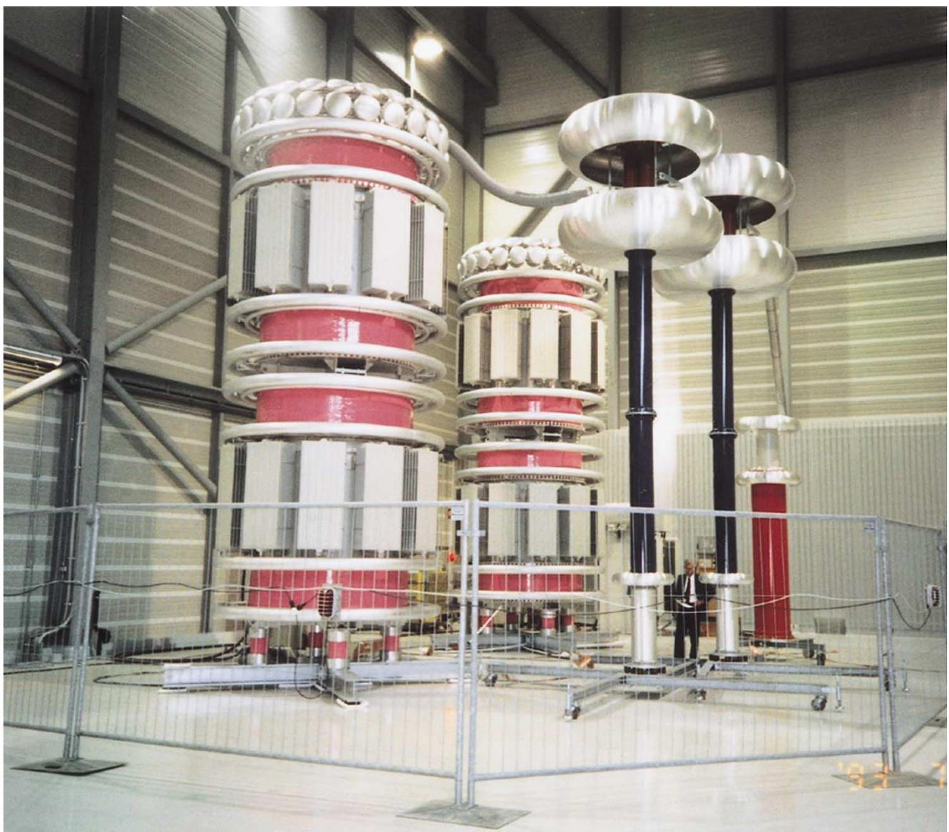
写真4 シリンダータイプ共振形交流試験装置
