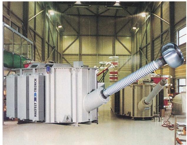
写真3 タンクタイプ共振形交流試験装置
