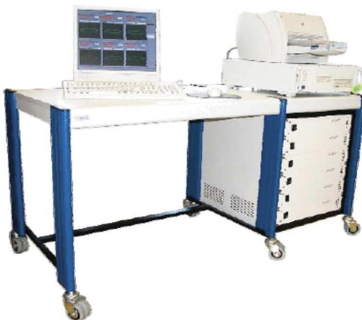
写真7 部分放電測定器タイプ（DDX9121）
