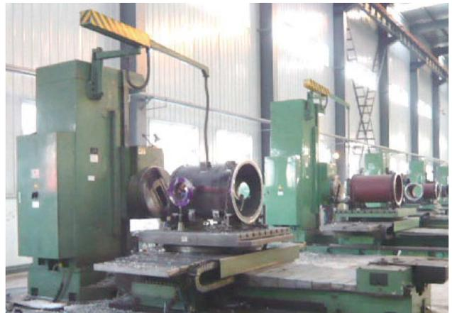
図4 中ぐり盤での加工状況
