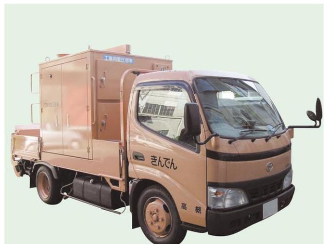
図12 工専用変圧器車 型
