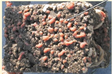
図5 ハイキューブへの生物付着状態(例)
