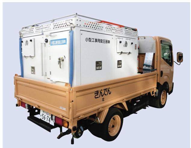
図22 小型工専用変圧器車
