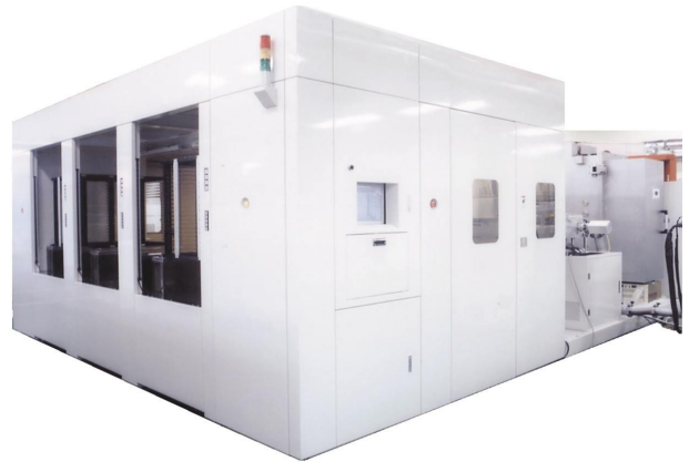
図2 FPD製造用イオン注入装置 iG4v3HS
