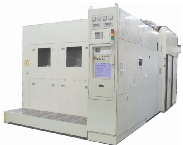
図1 半導体製造用イオン注入装置 IMPHEAT
