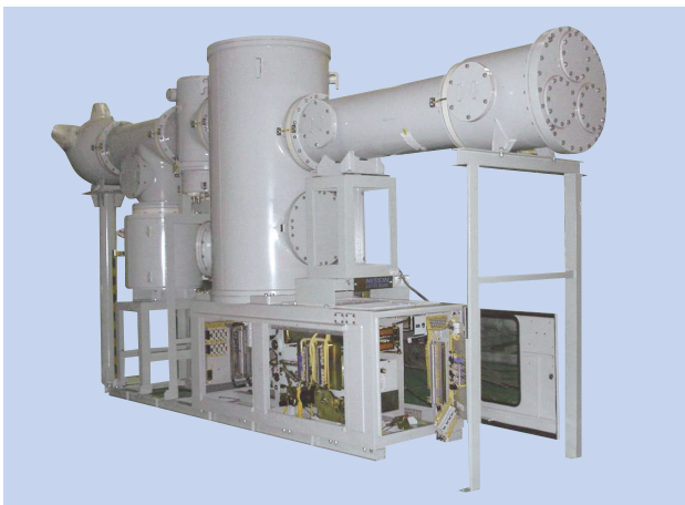
図3 北京宏達日新電機有限公司にて製造中のタイ向けGIS
