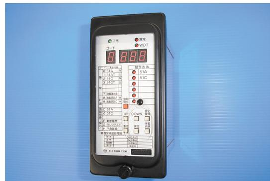
図12 高調波検出継電器 (D1UHR形) 999
