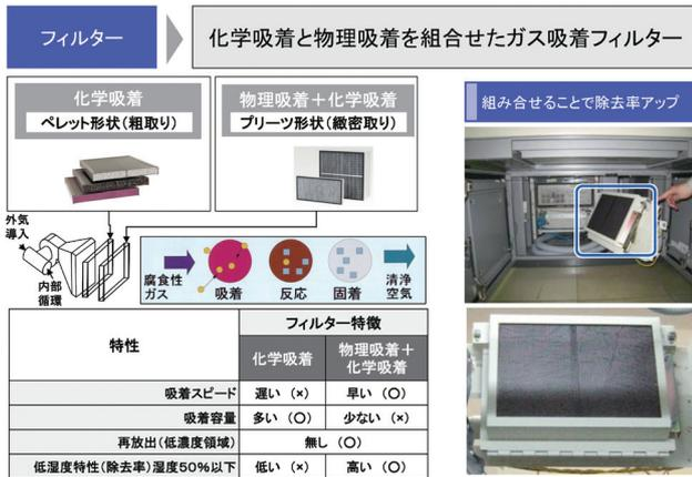
図6 ガス除去フィルター
