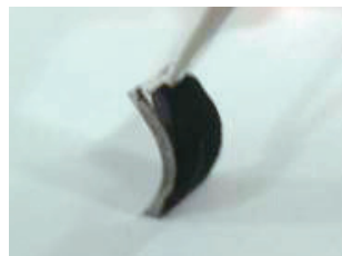
図7 (b) シリコンシートへ転写したCNWサンプル
