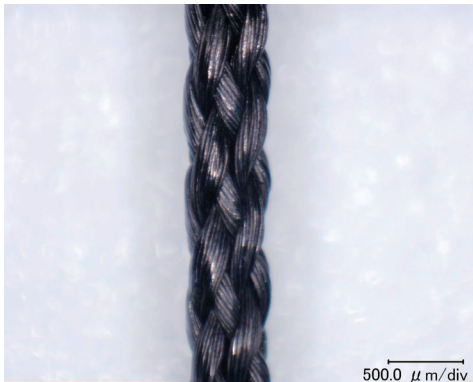
図2 (c) CNT合撚糸を用いて作製した組紐
