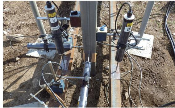
図 3.2.7(a) 杭基礎引抜試験状況
