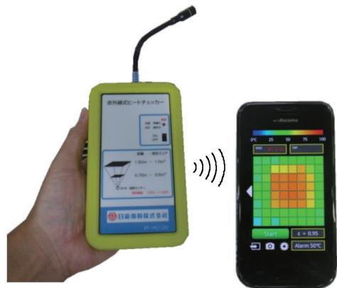
図 3.5.6 可搬型過熱検出センサとスマートフォン
