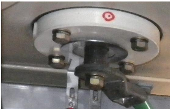
図 3.5.3 アンテナセンサ（電磁波法）
