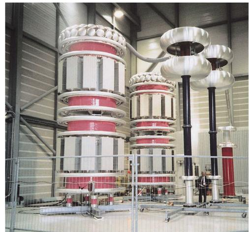
図15 550kV 52MVA交流試験装置
