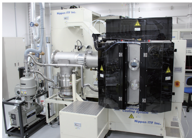
図2 当社製PVDコーティング装置「M500C-303型」 (1)
