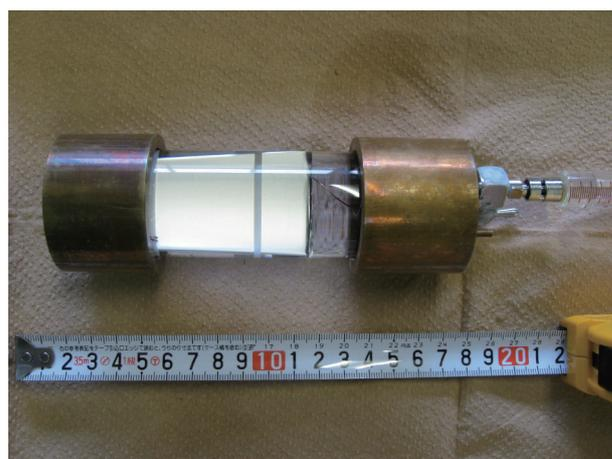
図1 モデルコンデンサの外観
