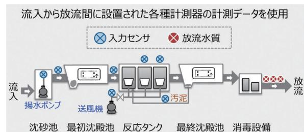
図10 下水処理施設と各種計測器の設置位置
