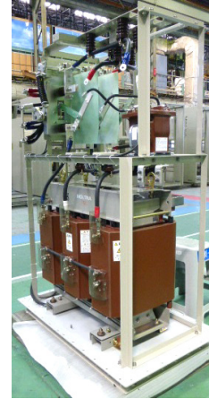
図5 内部フレームに取り付けた内部機器
