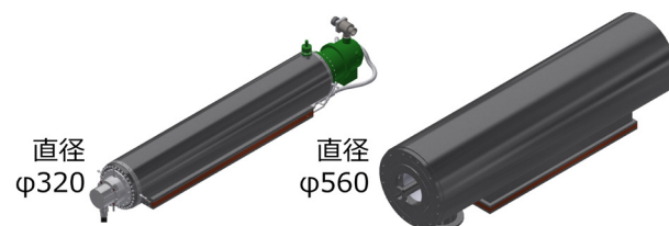
図1 Table EB照射ヘッド部のモデル（左）と従来型装置の照射ヘッド部（右）の外観図
