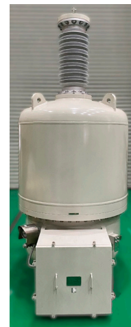
図3 実証試験用PVT (66kV, 100kVA)
