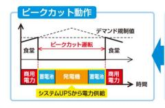
商用電力からシステム UPSに切り替えること で、発電機が立ち上が るまでの時間を蓄電池 に貯めている電気を活 用し、発電機が動いたら 切り替え活用します。
